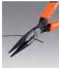
Spisstenger brukes også ved monteringsarbeid. De slanke kjeftene gjør arbeidet lettere på trange plasser.
