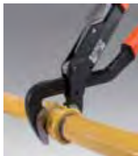
Vannpumpetenger. Vannpumpetenger har justerbart ledd som betyr stor Gripevidde og fast grep om emner med varierende form.
