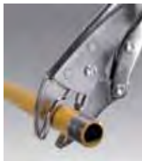
Gripe-/Sveisetenger brukes mest til å holde fast og fiksere emner som skal sveises eller boltes sammen.
