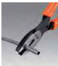
Kombinasjonstenger har både klippende og holdende funksjon.
